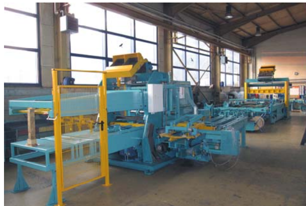
Kufennagelmaschine zur Herstellung der einzelnen Palettenkufen
