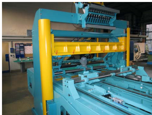
Montagemaschine für den Zusammenbau von Kufen und Deckel zur fertigen Palette
