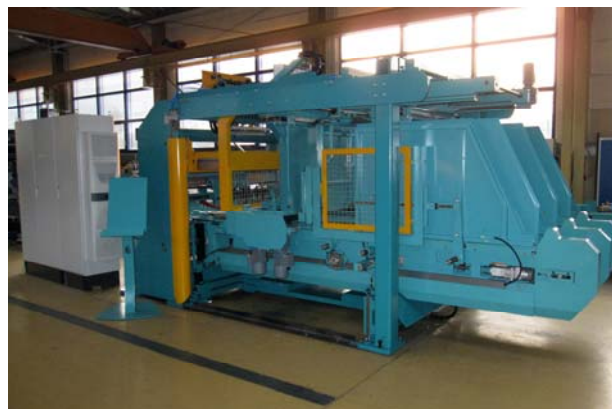
Deckelnagelmaschine für die Produktion der Palettendecks
