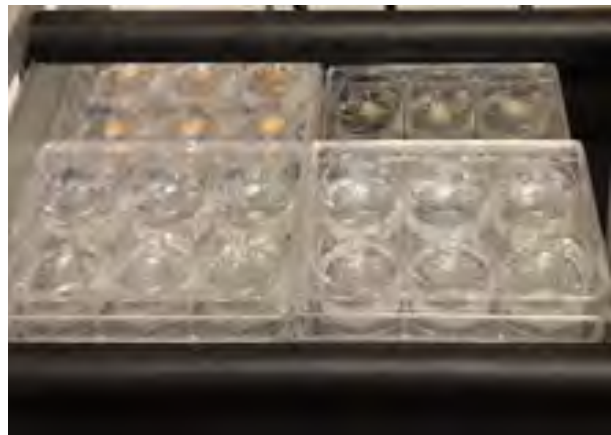
Abb. 3: Zellkulturplatten mit Prüfkörpern auf Glasperlen zum Ausschütteln
