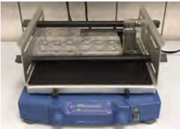
Abb. 2: Kreisschüttler mit Prüfansätzen
